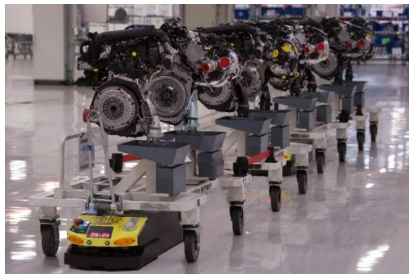
5. ábra Vontató AGV [8]
