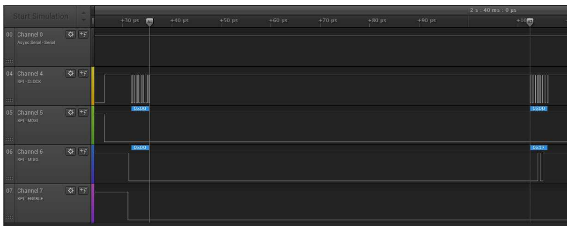
44. ábra ADNS-3080 SPI kommunikációjának mérési eredménye
