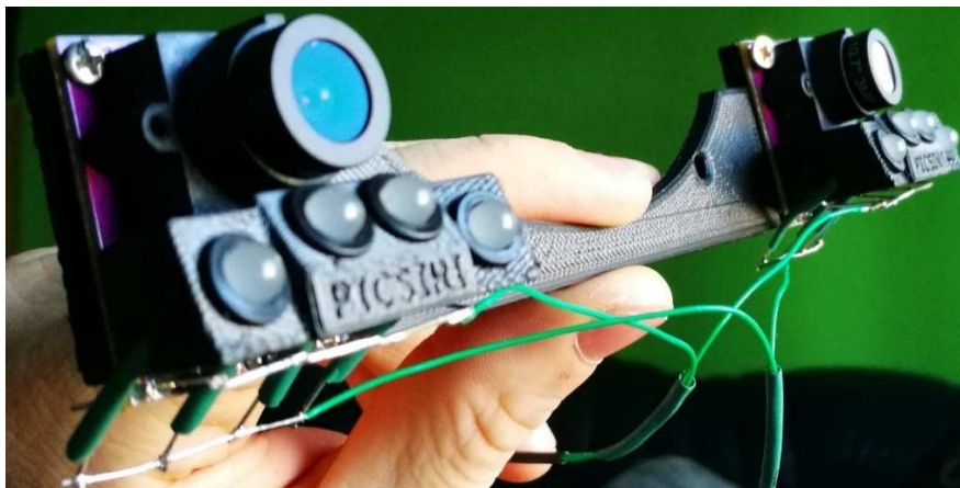
13. ábra ADNS-3080 és első tartója összeszerelve
