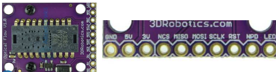
22. ábra ADNS-3080 modul és lábkiosztása
